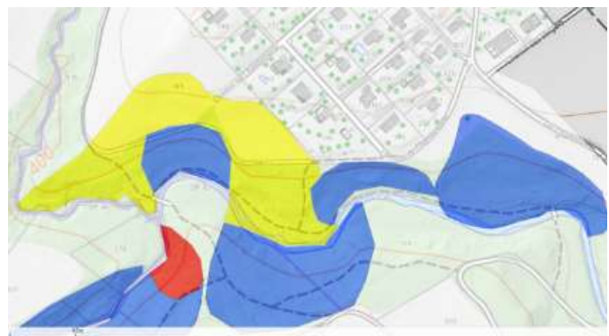
Carte des dangers de glissements de terrain : rouge : risque fort, bleu moyen, jaune faible
